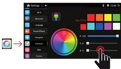
Otto colori di intensità al 100% sono a vostra disposizione premendo direttamente sulle icone colorate.
