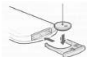
2) Inserire cella (3V), Chiudere il coperchio.
