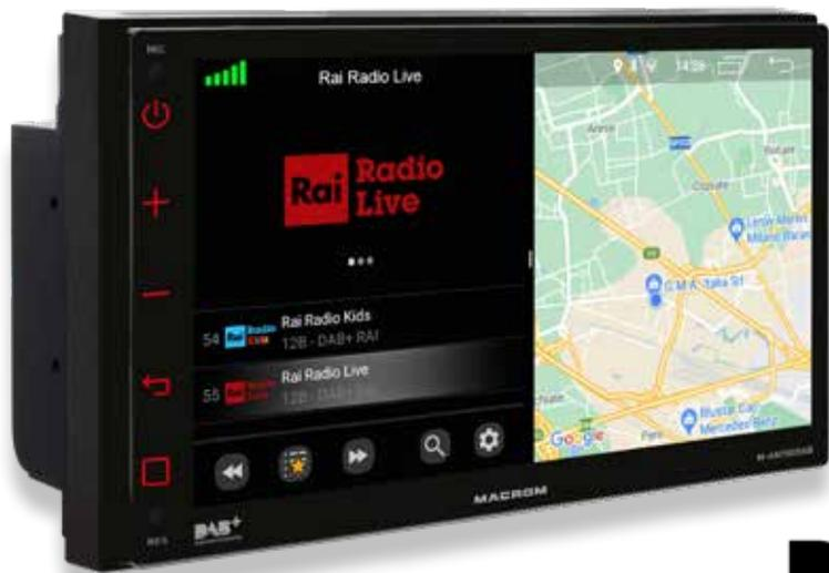
Il sistema operativo Android di Google offre la semplicità, la funzionalità e le prestazioni necessarie a portare il tuo multimedia a un nuovo livello. Grazie alla ridotta profondità di solo 4 centimetri è possibile effettuare l'installazione su ogni tipo di autoveicolo.
